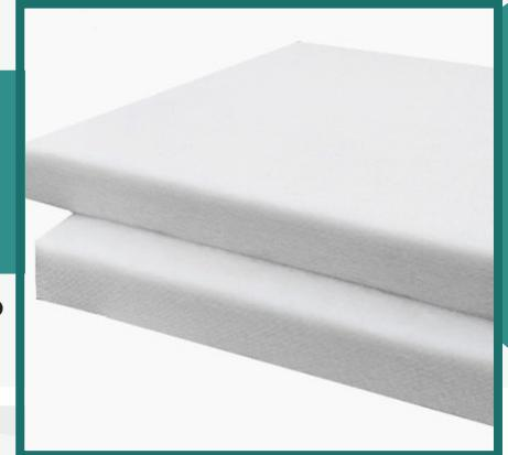
Το ECOLINE είναι ένα εξαιρετικό ηχοαπορροφητικό και θερμομονωτικό υλικό υψηλού δείκτη διαπνοής. Πρόκειται για ένα καινοτόμο ελληνικό προϊόν το οποίο είναι κατασκευασμένο από 100% πρωτογενείς και ανακυκλώσιμες ίνες καθαρού πολυεστέρα, σε πολλαπλά θερμοσυγκολλητά στρώματα, χωρίς καθόλου πρόσθετες συγκολλητικές ουσίες. Ανήκει στην οικολογική σειρά ηχοαπορροφητικών υλικών της Calma Acoustics. Οι ίνες καθαρού πολυεστέρα είναι πλήρως ανακυκλώσιμες και απόλυτα σταθερές σε βάθος χρόνου.
