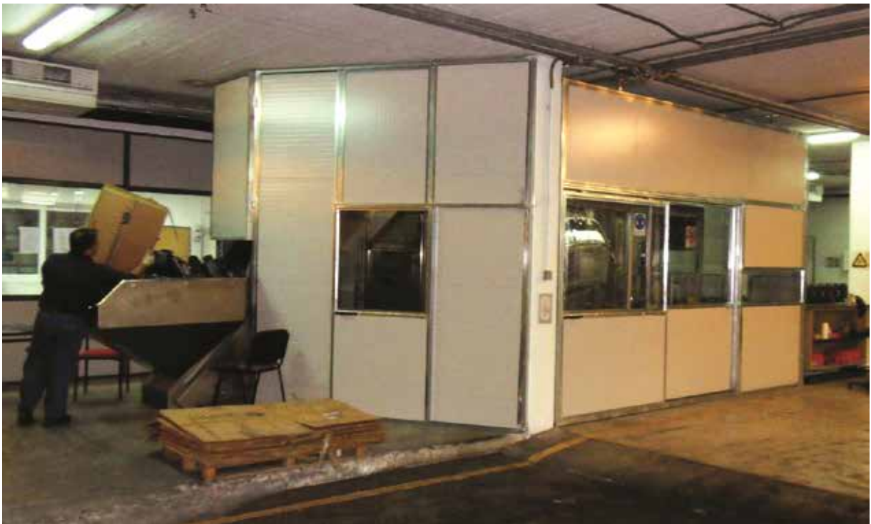
Ηχομόνωση γεμιστικής μηχανής ορυκτελαίων
