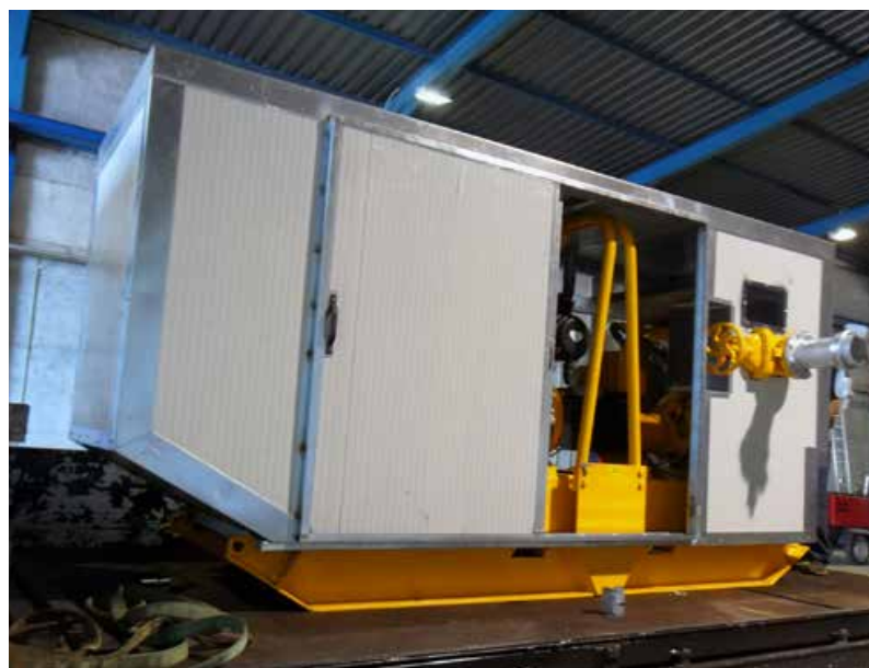
Ηχομόνωση φορητής πετρελαιοκίνητης αντλίας
