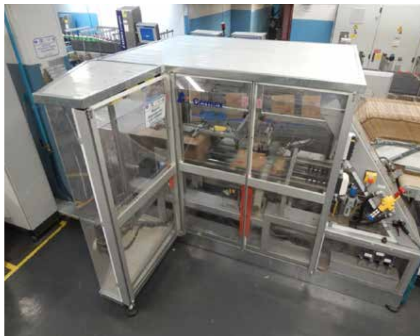
Ηχομονωτικό διαφανές κάλυμμα σε διπλωτική μηχανή χαρτοκιβωτίων
