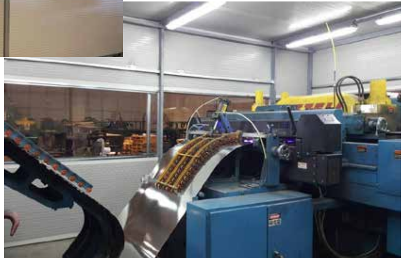
Ηχομονωτικός εγκιβωτισμός μηχανής χαλυβδοελάσματος
