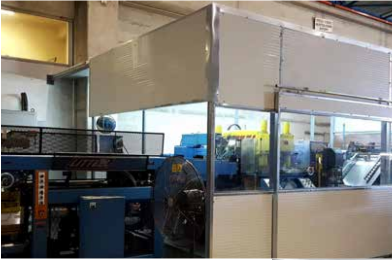
Ηχομονωτικός εγκιβωτισμός μηχανής χαλυβδοελάσματος
